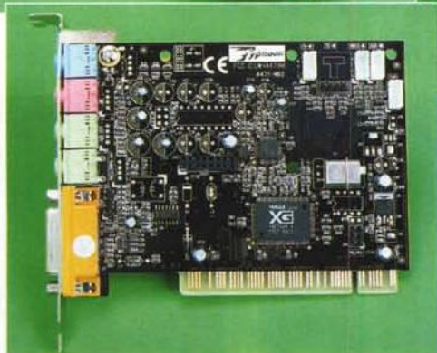
La Acoustic Five 3D è composta da due schede separate, montate a sandwich una sull'altra. Numerose sono le prese che troviamo direttamente sulla scheda. Oltre a due ingressi CD, differenti solo per il connettore adottato, sono presenti un ingresso video e uno ausiliario. Si noti che le prese esterne sono tutte duplicate. Si ha quindi un ingresso linea, un in microfonico, due uscite analogiche front e rear, e una presa digitale.
